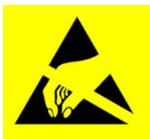
Descarga electrostática (ESD) de acuerdo con la norma IEC 61000-4-2. Use el dispositivo únicamente en un entorno con electricidad estática controlada.
